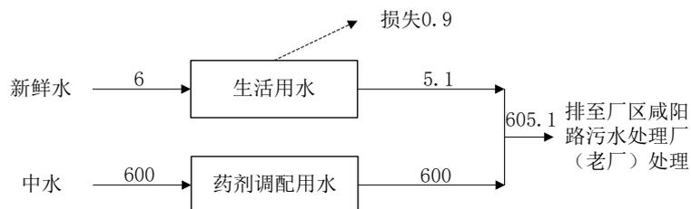
图 2.1-1 本项目水平衡图 单位 m<sup>3</sup>/d
